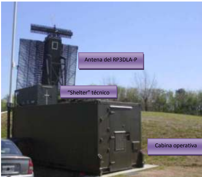
FIGURA IX – 27 – Vista general del sitio radar, con la cabina operativa en primer plano, más cerca de la antena el “shelter” técnico (que ya había sido visitado) y al fondo la antena del radar.
