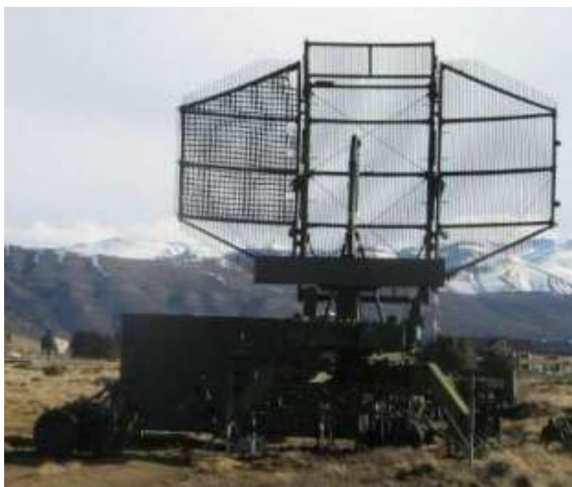
FIGURA IV 25 - Conjunto antena y shelter radar AN/TPS 43 E
