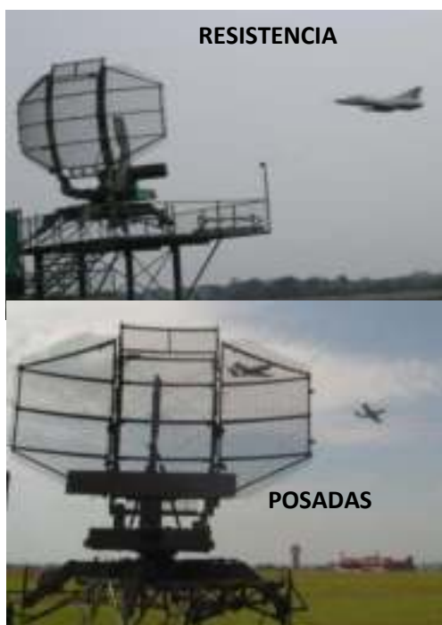
FIGURA VIII – 4 – Radares Westinghouse de la ZODANE, que primero integraron su información de plot al COAE de Merlo, Provincia de Buenos Aires.
